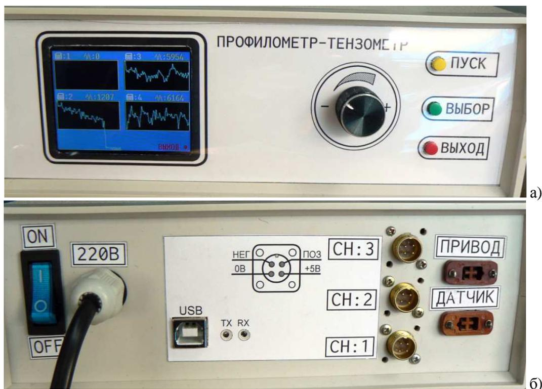
Рис. 3. Общий вид передней (а) и задней (б) панели устройства АПИ-2
